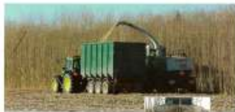
Ernte mit selbst fahrenden Maishäckslern mit Energieholz- Vorsätzen
