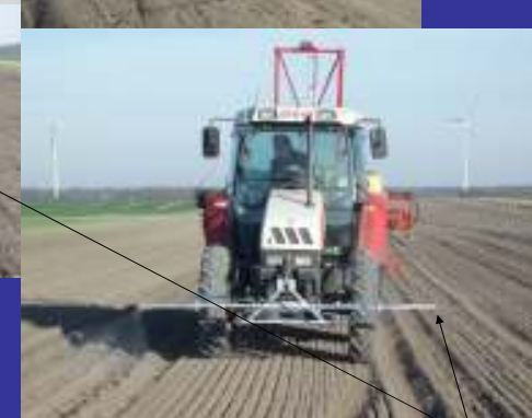
Parzellenspritze mit neu konstruierten Bandspritzbalken
